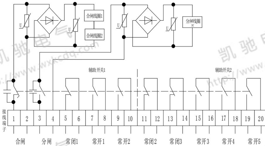
交流直流控制电原理及外接线图 (2开1闭或5开3闭)
